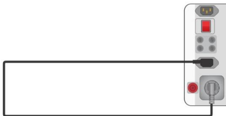
Figure 6.17: Continuity MS PE – IEC PE
