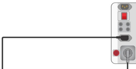
Slika 4.10: Kompenzacija upornosti merilnih vezi med omrežno preizkusno vtičnico in vtičnico IEC
